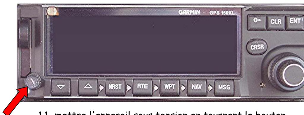
1.1 mettre l'appareil sous tension en tournant le bouton situé en bas, à gauche
